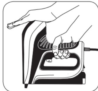
En superficies muy duras, el retroceso del disparo puede interferir con la penetración de los clavos o grapas. Mejore la potencia de clavado colocando firmemente una mano en la parte superior de la tapa.
